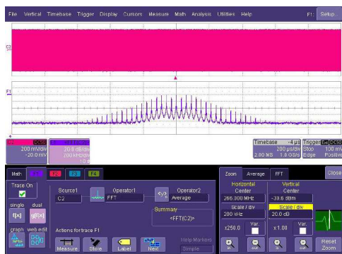
Fig. 4 La FFT (passage du domaine Temps au domaine Fréquence) est un moyen simple et rapide pour identifier clairement les sources de perturbations.
